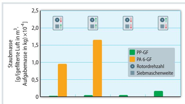
**Bild 3.** Einatembare Staubmasse, die bei der Zerkleinerung der Organobleche entstanden ist. Die Staubmasse ist durch die Masse des Aufgabeguts sowie die Menge der gefilterten Luft in m³ normiert worden.
